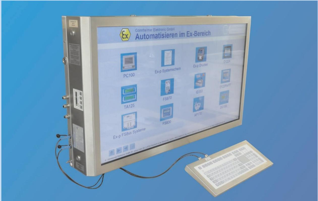
Widescreen 50 "con un dispositivo di input opzionale, ad esempio per consentire l'immissione o l'approvazione sul posto
