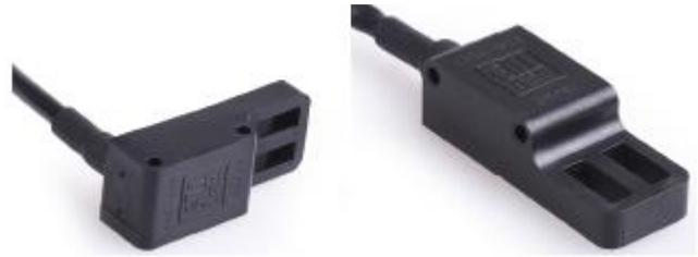
Il sensore di posizione a doppia uscita è un sensore senza contatto unico che misura la posizione lineare o rotativa di un attivatore metallico in modo accurato e ripetibile. Le caratteristiche di uscita del sensore sono determinate dalla forma e dal materiale dell'attivatore, che si muove all'interno di due cavità del sensore e produce un segnale relativo alla sua posizione.
