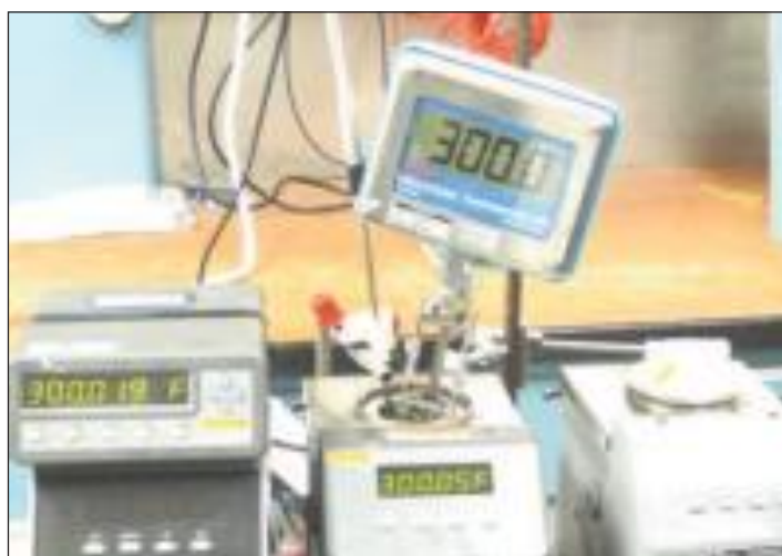
Sistema di termometro 600 in fase di test nel laboratorio di calibrazione di un importante robot da cucina, rispetto a due riferimenti certificati.
